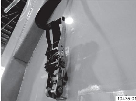
Spanngurt nach oben aus der Spannratsche herausziehen.
