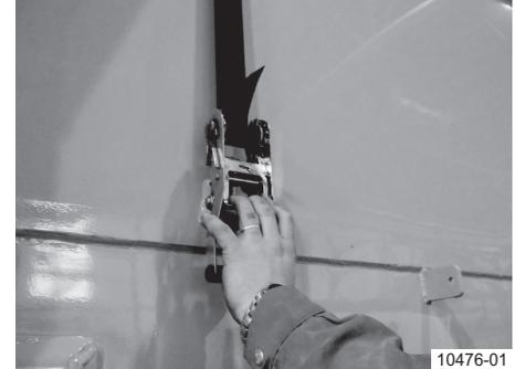
Sicherungsbügel der Spannratsche nach unten ziehen.
