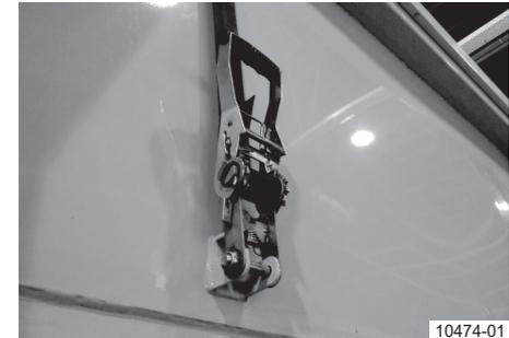
Griff mit gezogenem Hebel bis zum Anschlag nach oben drehen bis ein Knacken zu hören ist.
