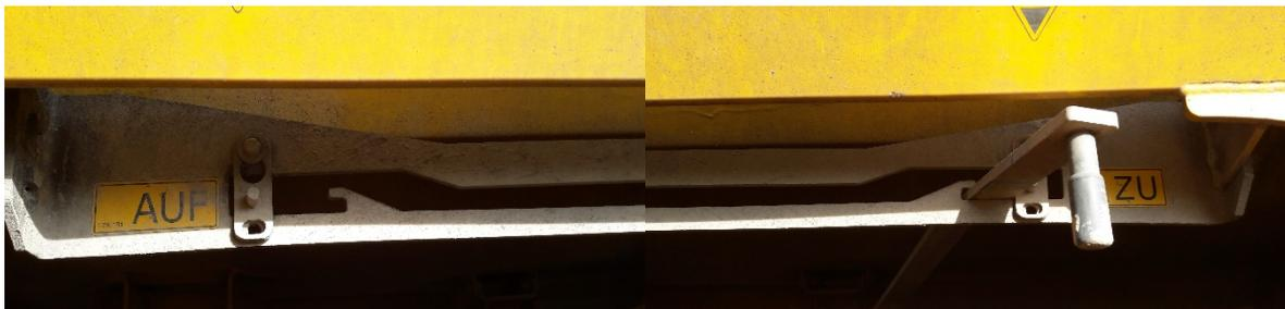
Abbildung IV: Beide mögliche Endstellungen des Schließmechanismus
