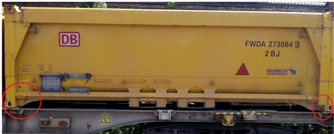
Abbildung VI: Zeigt Container auf Tragwagen. Markiert sind die Funktionsflächen und die Eckbeschläge, die den Container sichern und eine Verbindung herstellen.
