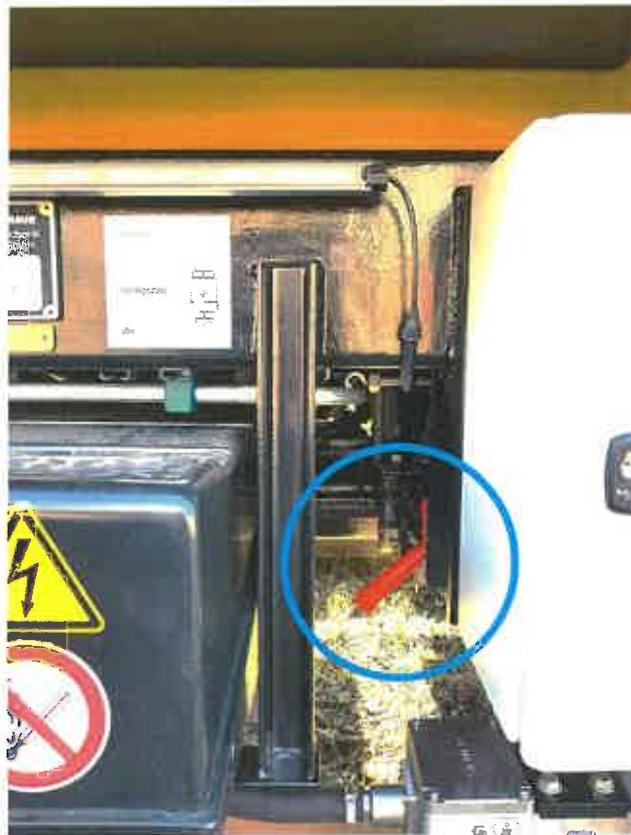
**Bild 18: Absperrhahn PZB „Betrieb – Störung“**
