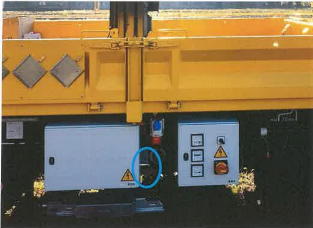
**Bild 3: Hauptschalter, Batterie**
