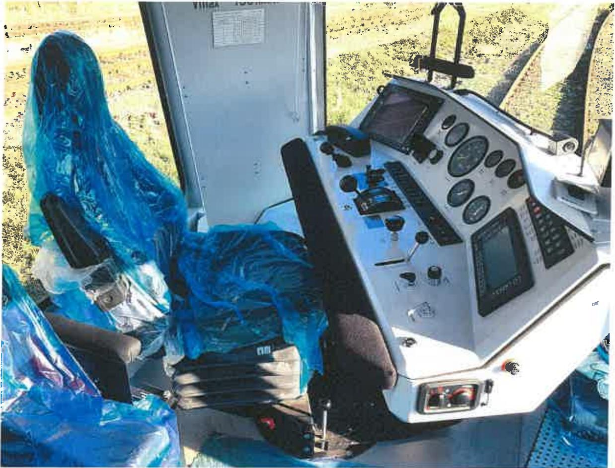
**Bild 1: Fahrersitz, drehbar mit dem Bedienpult gelagert**
