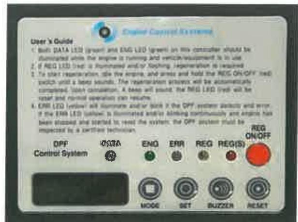
Wird das Fahrzeug ohne Freibrennen weiter betrieben, ertönt zusätzlich ein Signalton. Der Filter muss jetzt sofort freigebrannt werden, um Schäden zu vermeiden.
