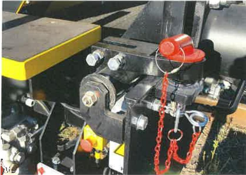
Die Schienen sind mit der Halterklaue und Klemmschrauben sowie dem Steckbolzen gegen Verrutschen zu sichern.
