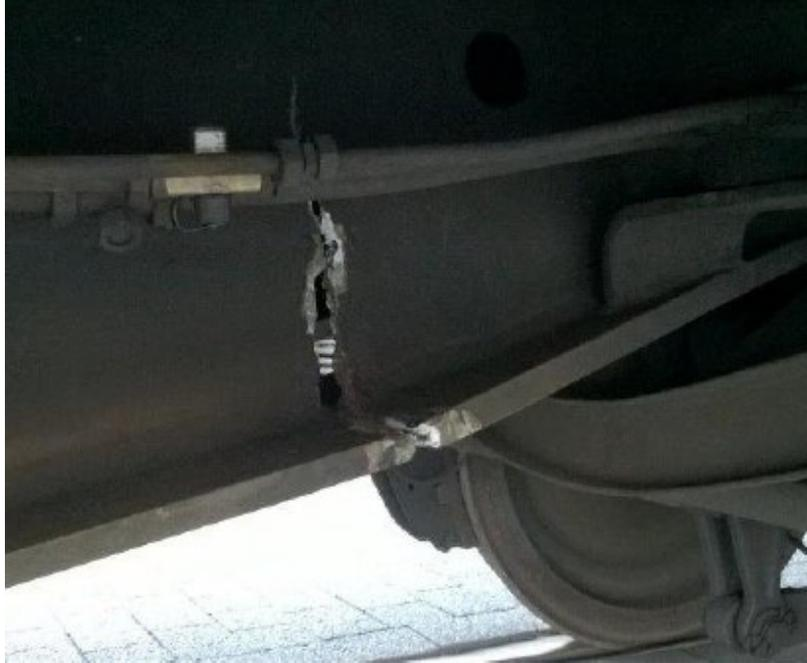
Bei jeder wagentechnischen Behandlung mit der oben genannten Bauart ist verstärkt auf den ordnungsgemäßen Zustand der Langträger zu achten. Es sind insbesondere die Schweißnähte in den äußeren Einzellastenbereichen ( c-c und d-d ) zu prüfen.
